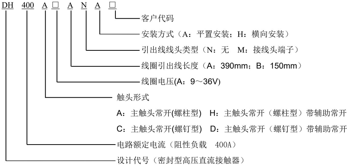
例: DH400AAANA;表示: 密封型高压接触器, 额定电流为 400A, 主触头常开(螺柱型), 不带辅助触头, 线圈电压 DC 9~36V, 线圈引出线长 390mm, 平置安装。
